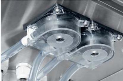
Dosaggio preciso del detergente, fino all'ultimo millilitro: le pompe di dosaggio dispensano con la massima accuratezza ed economia detergenti sia acidi che alcalini. Fornibile in opzione la terza pompa per il dosaggio di un prodotto disinfettante.
